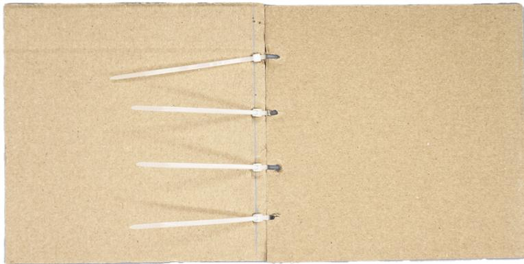
**Verbindung mit Kabelbinder**
